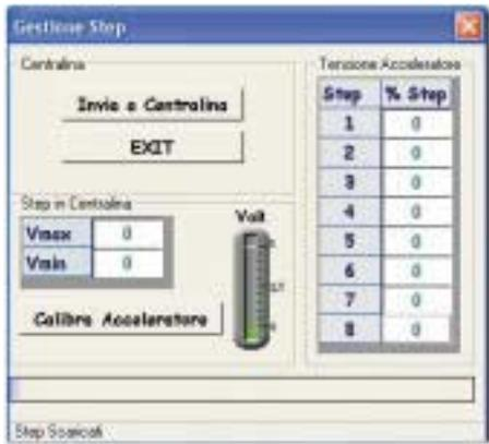
Inoltre, la GESTIONE STEP è una particolare funzione che permette di modificare gli 8 valori di percentuale dell'apertura della farfalla, per una personalizzazione e messa a punto estrema della moto.
