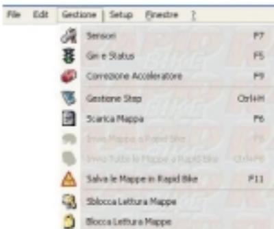
Ulteriore funzione disponibile è la correzione dell'acceleratore che permette di avere, per pochi istanti, un incremento di benzina fino al 5% in più rispetto alla mappa, durante l'accelerazione a pieno carico (F9).
